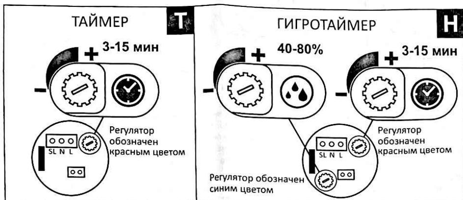
РИС.3 - Настройка таймера и гигротаймера
