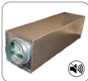
Глушитель канала, квадратный с круглым гнездом, жесткий. Внешний корпус изготовлен из оцинкованного стального листа, а внутренний корпус из полипропилена. Абсорбирующий материал для предотвращения миграции частиц в воздуховоде. Розетка с уплотнителем. Соединение ниппель/ниппель.
